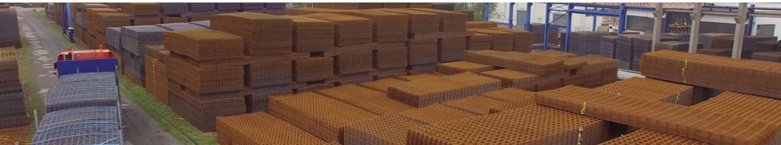
Mit hocheffizienter Anlagentechnik fertigen wir am Standort Salzgitter kalt-gerippten Betonstahl (KR) in Ringen und Coils, sowie Lagermatten. Durch spezielles Walzdraht-Vormaterial für unsere KR-Produkte, welches wir in enger Kooperation mit unseren Lieferanten entwickelt haben, erreicht unser Bewehrungsdraht erstklassige technische Werte, insbesondere bei der Dehnung und dem Verhältnis  $R_e/R_m$ .
